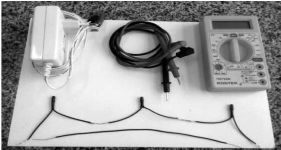
Figura 5 – Aparato experimental para experimento de circuitos resistivos
